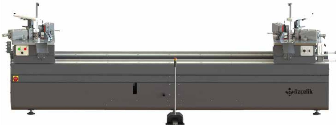
**Com capacidade para montar simultaneamente duas extremidades do perfil, a APEX - II oferece soluções rápidas para os usuários com a potência do sistema hidráulico.**
