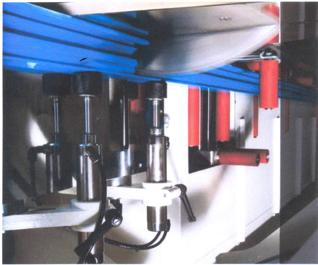
**Machine de coupe automatique et numérique avec lame frontale Ø 550 mm avec système robot de commande de profils**
