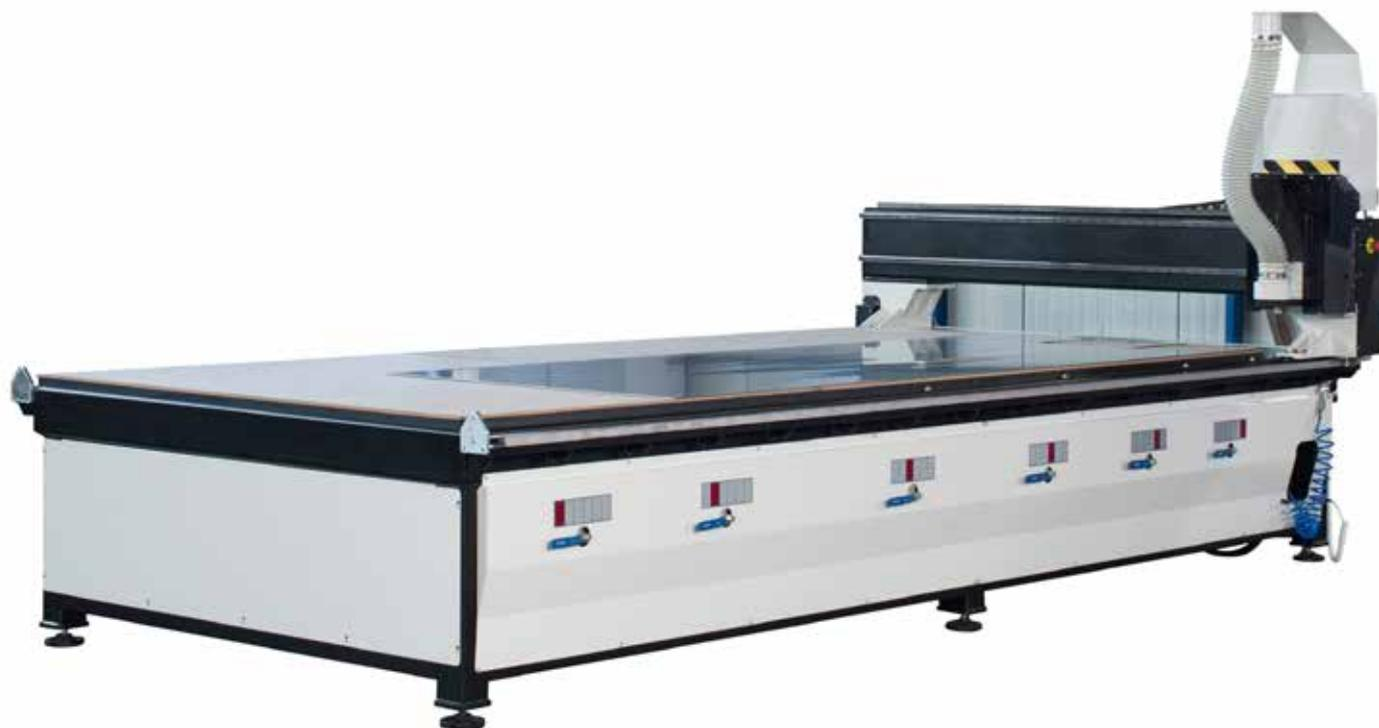
**A processadora de painéis CNC com três eixos LEPUS - I destina-se a operações de corte, abertura de canais em V e operações similares em diversos painéis e placas de compósito. Além disso, a máquina permite o processamento de materiais de madeira, plástico e diversos materiais por meio da substituição do cortador de usinagem.**
