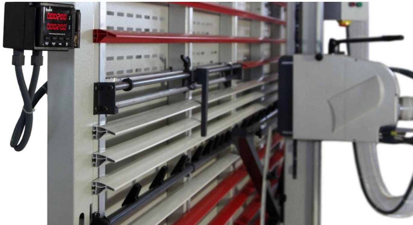
VISUALIZZATORI DIGITALI PER MISURE DI TAGLIO IN ORIZZONTALE E VERTICALE
