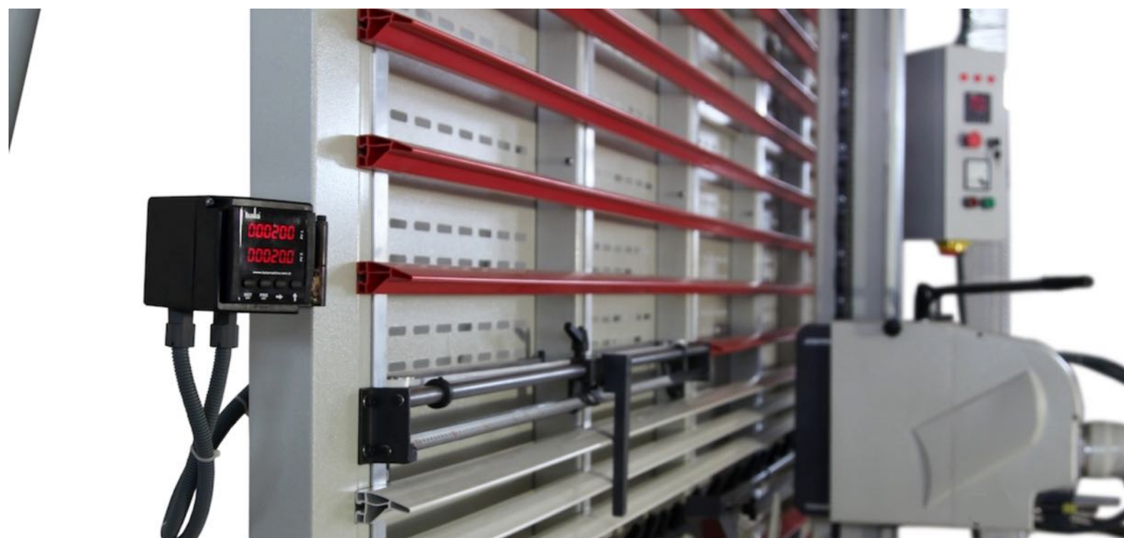
Visualizzatore Digitale per Misure Tagli e Fresature Orizzontali e Verticali (di serie).
