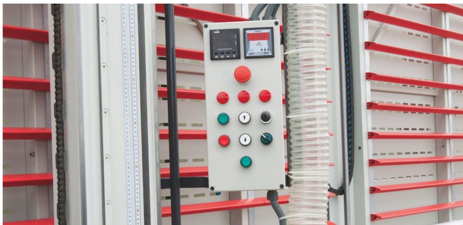
Visualizzatore Digitale per Misure Tagli e Fresature Orizzontali e Verticali (di serie).
