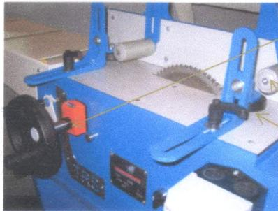
**Volante de regulación milimétrica del corte seccionado.** Mediante el giro del volante y gracias al medidor mecánico o digital es posible realizar cortes milimétricos de los perfiles.
